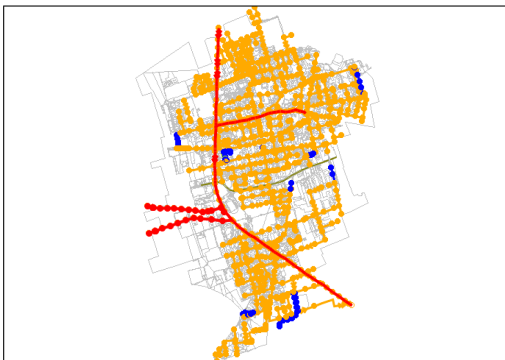
Figura 1: rappresentazione modellistica del sistema di drenaggio integrato (in rosso i collettori intercomunali)
