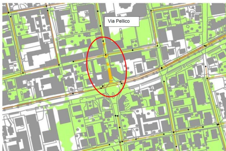
Figura 3: Aree con criticità idraulica dovute alla fognatura T50 in via Pellico
