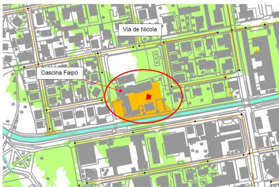
Figura 2: Aree con criticità idraulica dovute alla fognatura T50 in zona Cascina Faipò
