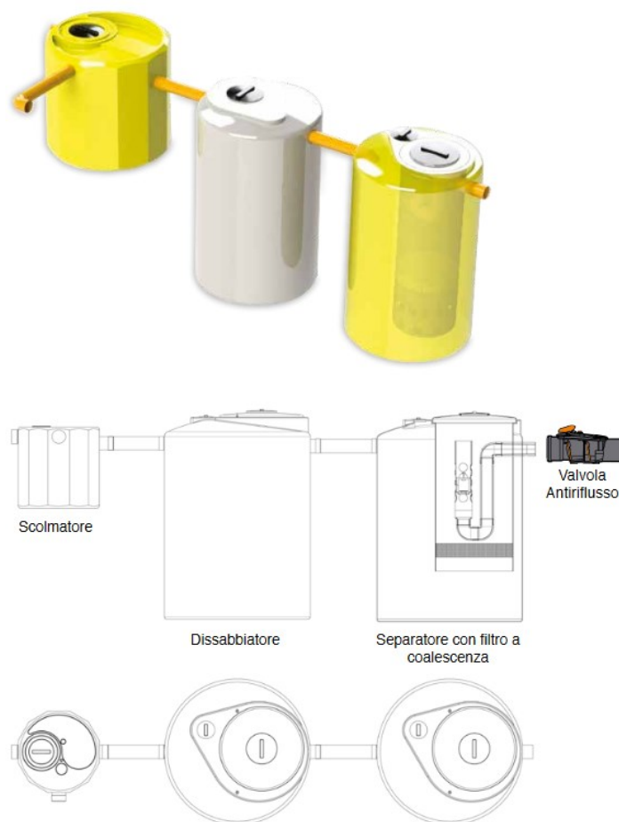
Figura 4: schema impianto trattamento acque di prima pioggia in continuo
